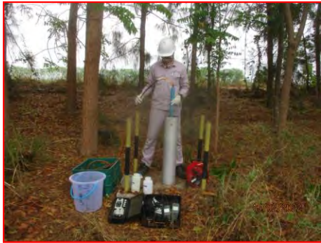
ภาพที่ 2.2-33 บ่อสังเกตการณ์ (Monitoring Well)
